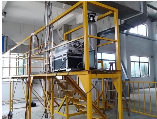
图 4-3 油烟净化设备去除效率台架实验平台
